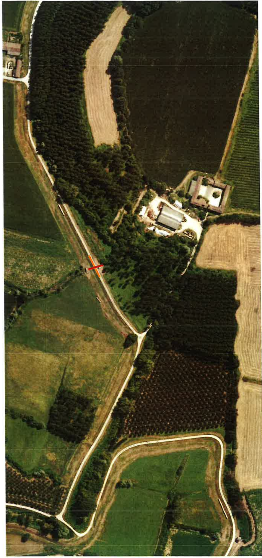
Estratto dal Geoportale di Regione Lombardia di un tratto di Argine maestro del Fiume Oglio in comune di Ostiano ove è necessario eseguire un intervento di rinforzo (colore arancione) in quanto la canna della Chiavica Poffa che lo attraversa (colore rosso) è frantumata
